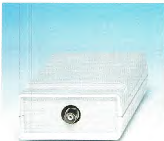
Fig.11 Questo trasmettitore possiede una sintonia che va dal canale 21 al canale 69 della banda UHF. Per impostare il canale di trasmissione usate i due commutatori.
