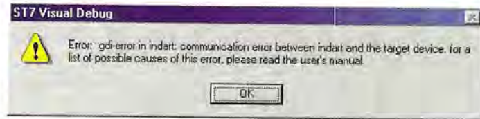
Fig.20 Quando non si stabilisce una corretta comunicazione tra le schede, può apparire anche questo messaggio di errore.
