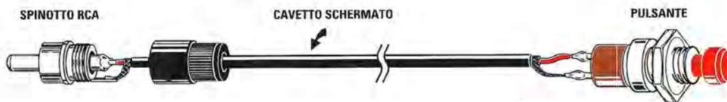
Fig.10 Per eseguire le vostre prime esperienze con questo circuito all'interno del blister del kit troverete uno spinotto RCA che potrete collegare per mezzo di uno spezzone di cavetto schermato al semplice pulsante visibile a destra. Seguite le informazioni contenute nell'articolo e avrete conferma delle potenzialità di questo progetto.
