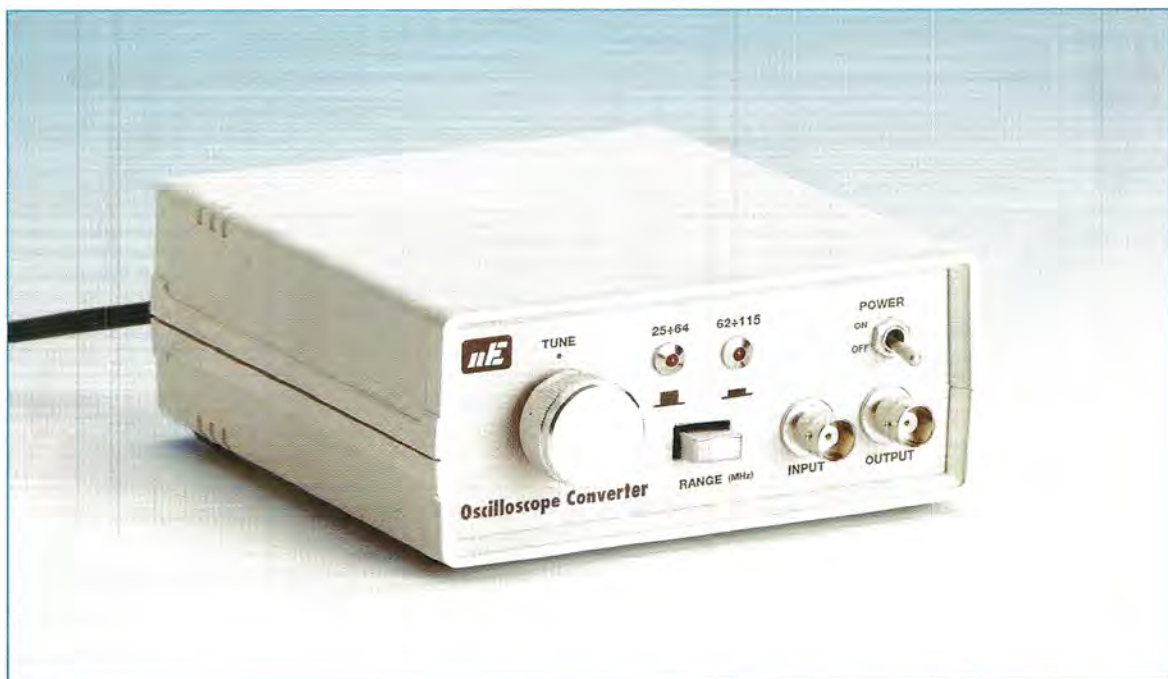
Fig.6 Ecco come si presenta il nostro Convertitore di frequenza per Oscilloscopio una volta inserito entro il suo mobile plastico. Sul pannello frontale sono visibili a sinistra la manopola del potenziometro R8 di sintonia e al centro il tasto rettangolare del commutatore S1-A e S1-B e sopra a questo i due diodi Led che indicheranno quale gamma di frequenza (25-64 MHz o 62-115 MHz) avete selezionato.
